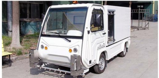
Transcarga M-Size equipado con una caja cerrada tipo 'VAN' y con sistema de aspersión de suelos.
