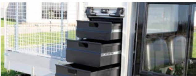
Zona de carga mixta, combinando armario cerrado con cajones y pick up con laterales sobre elevados de reja para recogida de poda.
