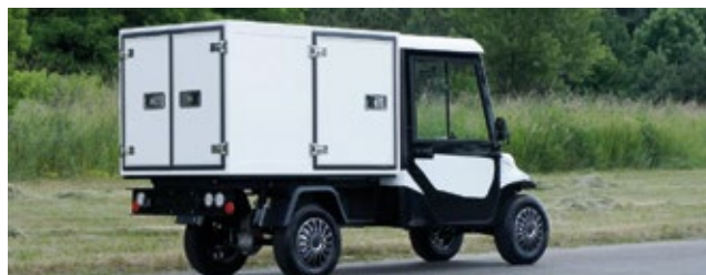
Configuración de caja cerrada con acceso posterior y lateral de 1750x1240x1150 mm
